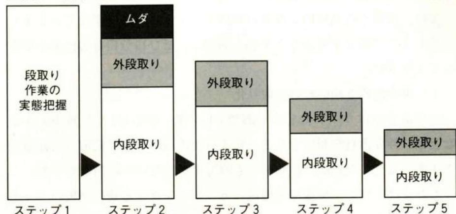
法やビデオ撮影などの手法を用いて、稼働時間に占める段取時間の割合や作業方法の実態を把握します。
